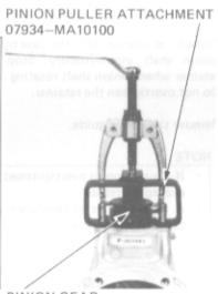
PINION GEAR PULLER ATTACHMENT 07934-MA10200
